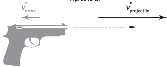
• Avant le tir, le système {arme à feu + projectile} est au repos dans le référentiel terrestre considéré comme galiléen : c'est un système isolé.
