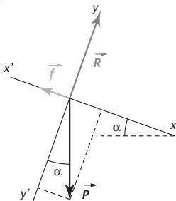
D'après le principe d'inertie:  $\vec{P} + \vec{R} + \vec{f} = \vec{0}$ .
