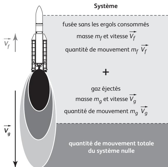
$\vec{p}_{\text{initiale}} = \vec{p}_{\text{finale}}$  ce qui donne :  $\vec{0} = m_f \vec{v}_f + m_g \vec{v}_g$
