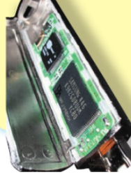
L'intérieur d'une clé USB. Les données sont contenues dans la puce noire de gauche.
